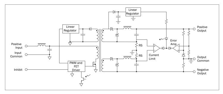
FIGURE 2: SMHF42 DUAL OUTPUT, BLOCK DIAGRAM
